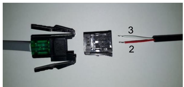
Lämpötila sensorin kaapelien kytkentä
