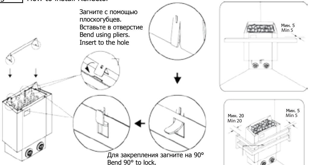
Рис. 2 | Установка теплоотражателя Fig. 2 | How to install Reflector
