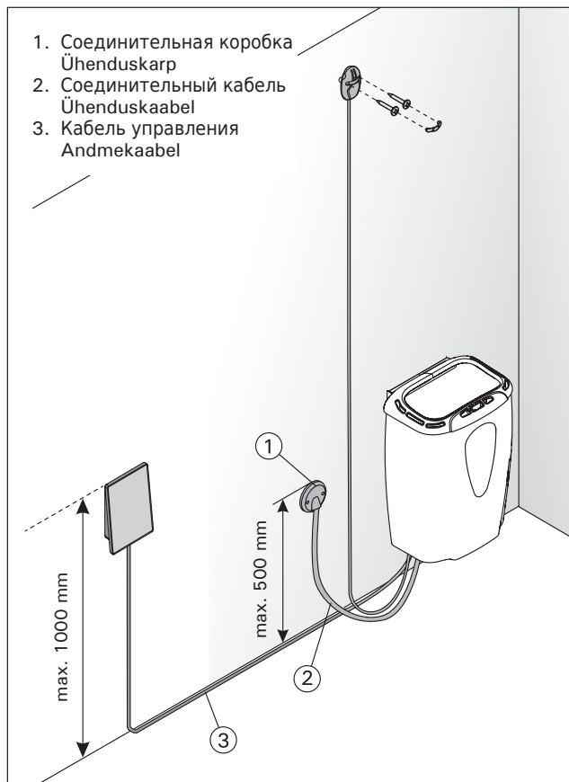
Рисунок 11. Установка каменки
