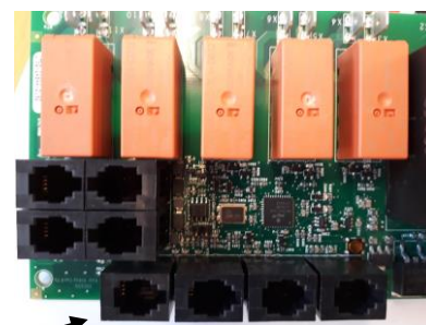
Illustration 4 . Ordre des connecteurs RJ 10. Capteur, interrupteur de porte, télécommande, capteur NTC supplémentaire.
