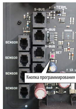
Обратная сторона пульта управления - плата с 4-мя портами для подключений.
