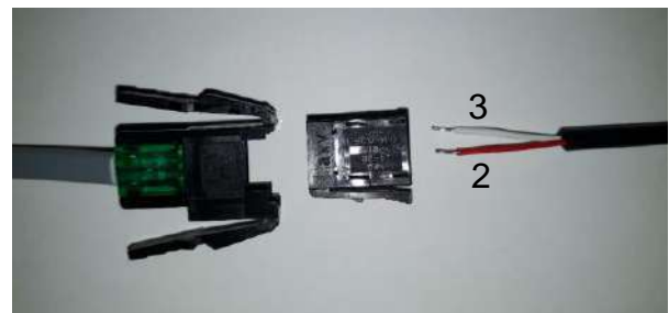
Anslutning av temperatursensorns kabel
