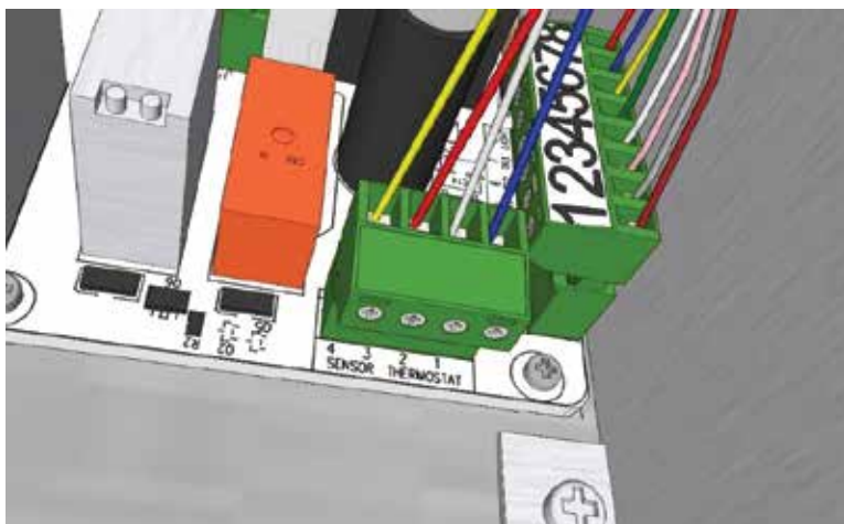
Расположение проводов на монтажной плате справа налево.
